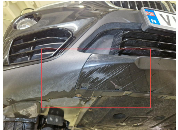
1.2 Skrubbskader underkant frontfanger, normal bruksslitasje
