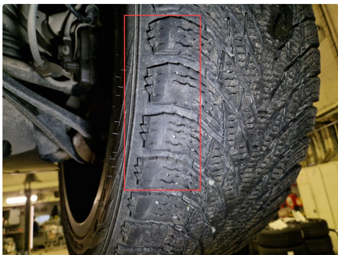
1.6 Noe skjeivslitasje innside vinterdekk h+v bak . ( Normal bruksslitasje )
