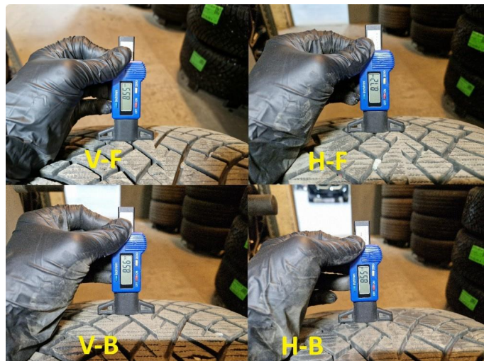
1.2 Dekkdybdemåling vinterdekk utført 17.07.2026 på km : 17.377.
