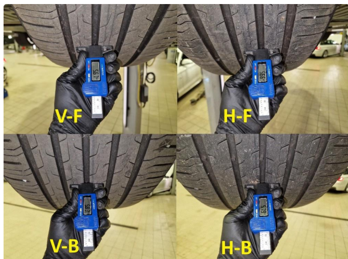
1.1 Dekkdybdemåling sommerdekk utført 17.07.2026 på km : 17.377.
