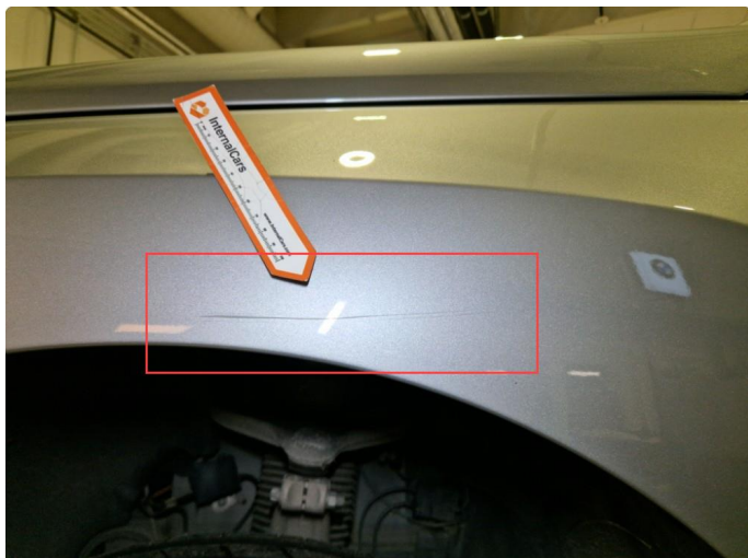
1.2 Bruksmerke v-framskjerm ( Normal bruksslitasje )
