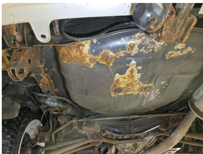
2.2 Rust underside ved bakstilling.
