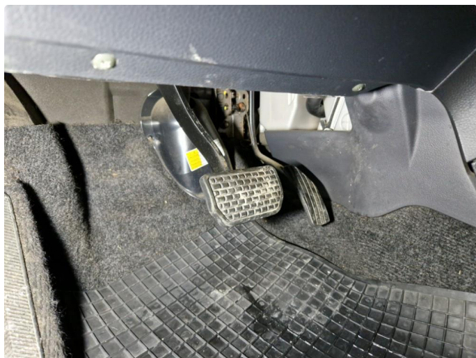
5.1 Lang vandring brems pedal, pedal går i bunn + dårlig effekt brems pedal.
