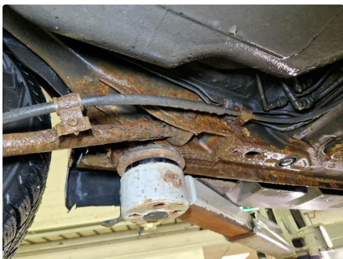
2.2 Rust underside ved bakstilling.
