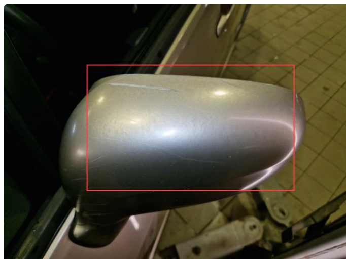
2.1 Generelt mye lakkslitasje, bulker, riper og noe rust. Noen paneler er trolig opplakkert da det vises mye struktur og støvkorn i lakk
