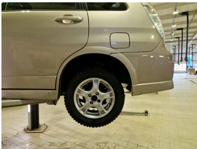
2.7 Mangler 1 stk hjulmutter v-ram og 1 stk v-bak.
