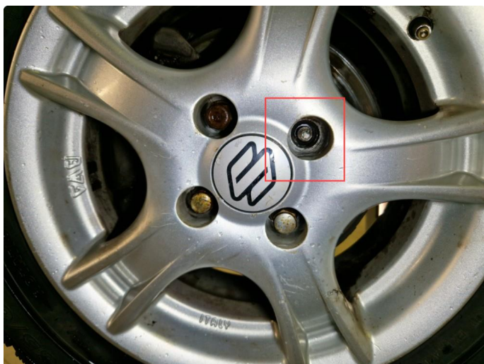
2.7 Mangler 1 stk hjulmutter v-ram og 1 stk v-bak.
