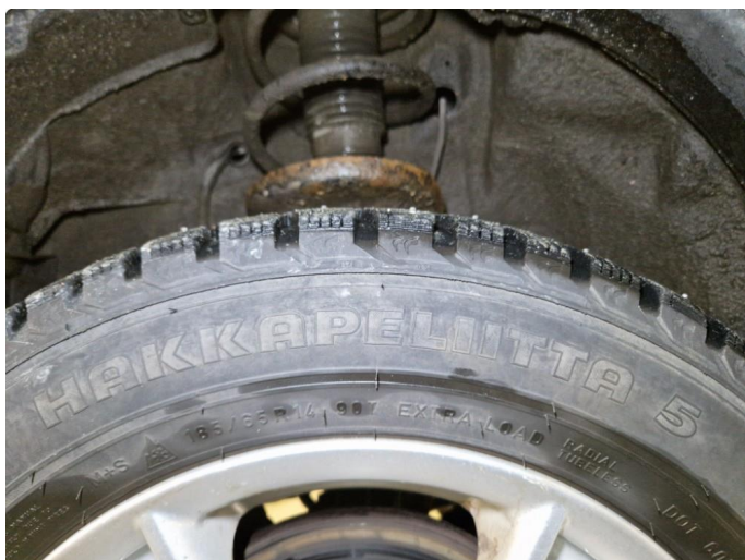
2.4 Vinterdekk produsert 17/2012 Nokian Hakkapelitta 5 185/65R 14 90T Piggdekk
