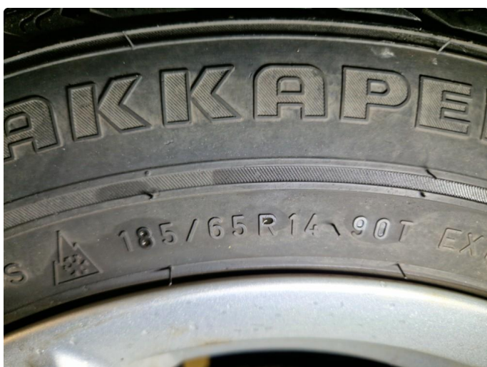
2.4 Vinterdekk produsert 17/2012 Nokian Hakkapelitta 5 185/65R 14 90T Piggdekk
