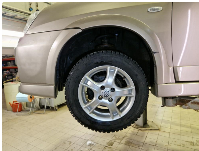
2.7 Mangler 1 stk hjulmutter v-ram og 1 stk v-bak.
