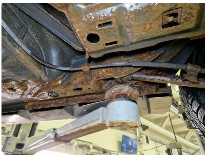
2.2 Rust underside ved bakstilling.
