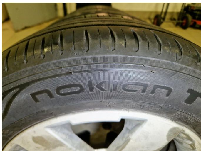
2.3 Sprekkdannelser sommerdekk. Nokian Hakkapelitta Green 3 185/65R 15 92H
