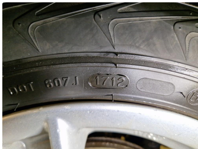
2.4 Vinterdekk produsert 17/2012 Nokian Hakkapelitta 5 185/65R 14 90T Piggdekk
