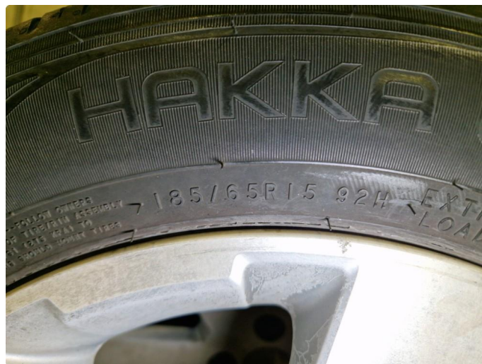
2.3 Sprekkdannelser sommerdekk. Nokian Hakkapelitta Green 3 185/65R 15 92H
