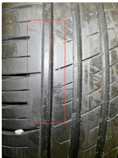
2.3 Sprekkdannelser sommerdekk. Nokian Hakkapelitta Green 3 185/65R 15 92H
