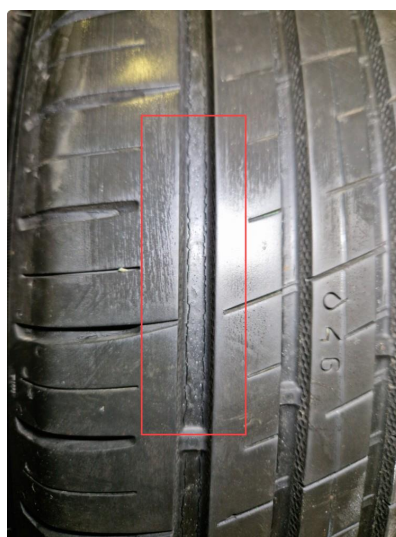
2.3 Sprekkdannelser sommerdekk. Nokian Hakkapelitta Green 3 185/65R 15 92H
