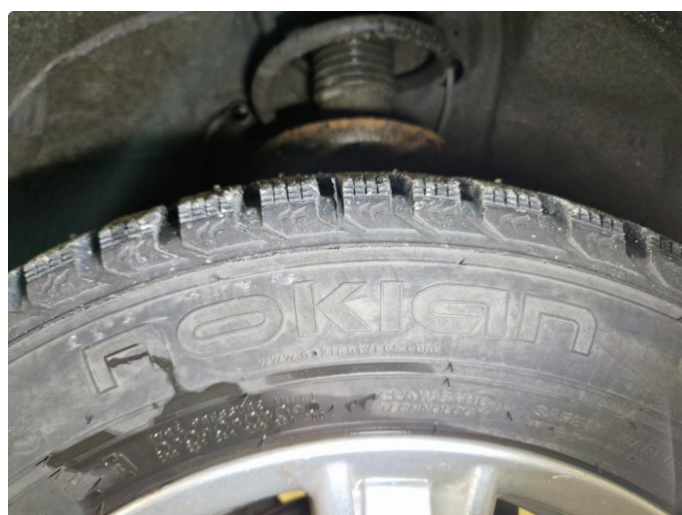
2.4 Vinterdekk produsert 17/2012 Nokian Hakkapelitta 5 185/65R 14 90T Piggdekk
