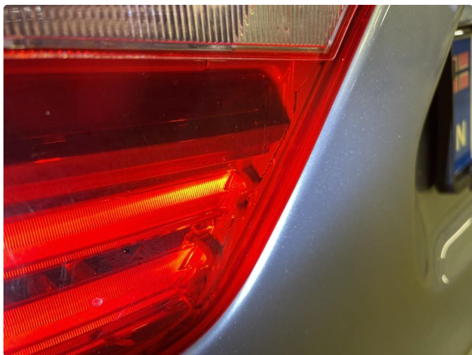
3.1 Sprukket opp innvendig.
