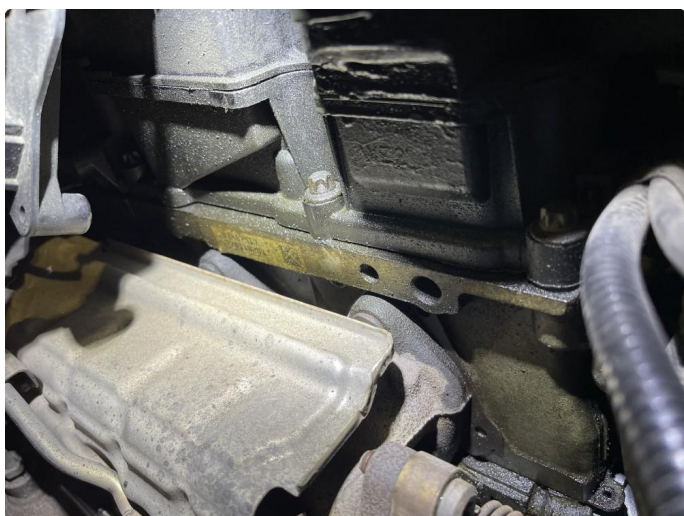
4.1 Lekkasje/svetting fra toppdeksel.
