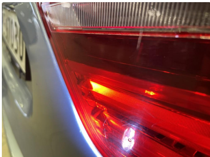
3.1 Sprukket opp innvendig.
