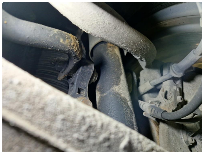
5.1 Lekkasje støtdemper h-side bak
