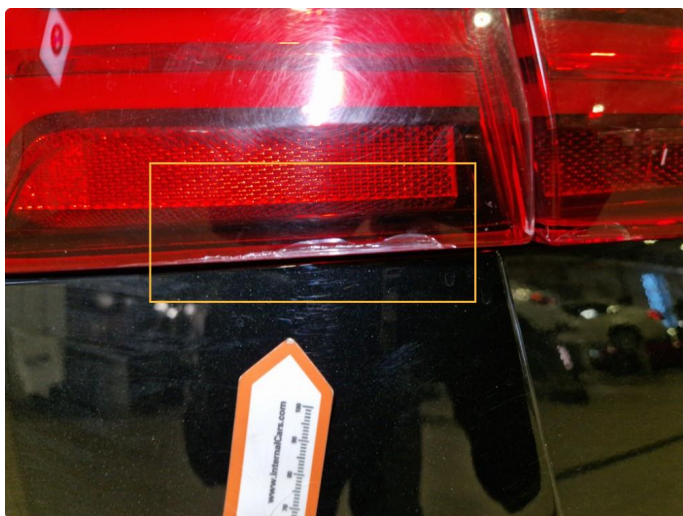
3.2 Sprekkdannelser indre + ytre baklykt nedre del v-side.
