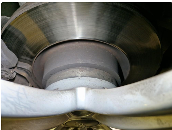
2.6 Spacere er montert begge sider fram og bak.
