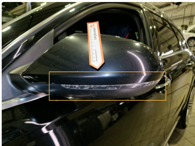
2.3 Sprukket lykteglass blinklykt i speil v-side.
