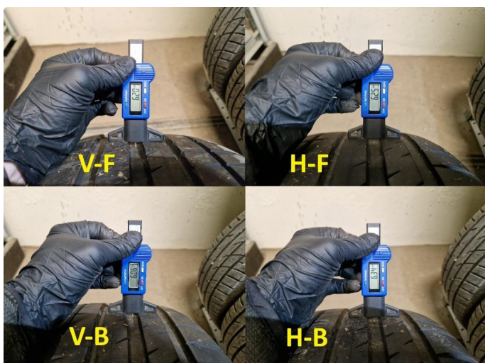
1.2 Dekkdybdemåling sommerdekk utført 11.02.2026 på km : 27.977.
