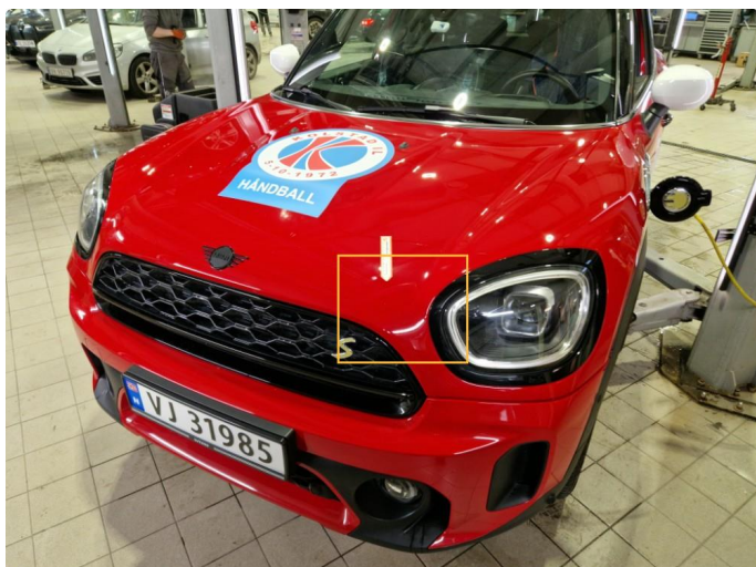
1.1 Noen steinsprut panser, ikke ut over normal slitasje.
