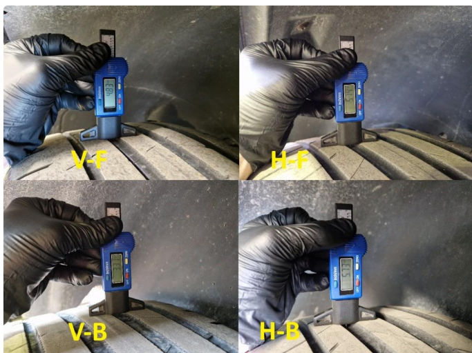
1.1 Dekkdybdemåling sommerdekk utført 28.04.2026 på km : 123.488.
