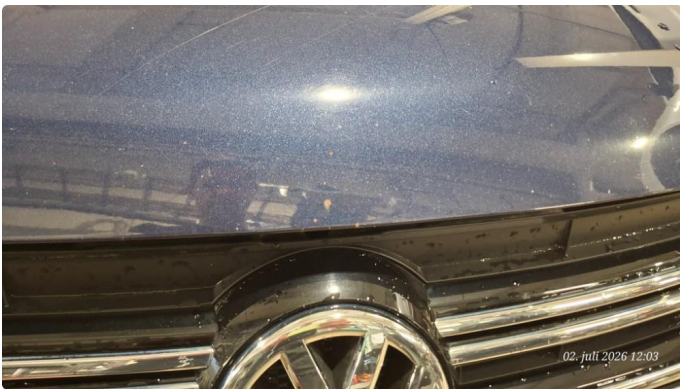
1.2 Noe steinsprut med rust
