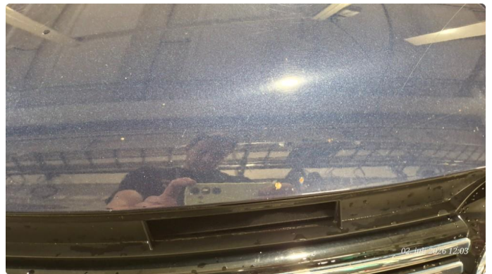
1.2 Noe steinsprut med rust
