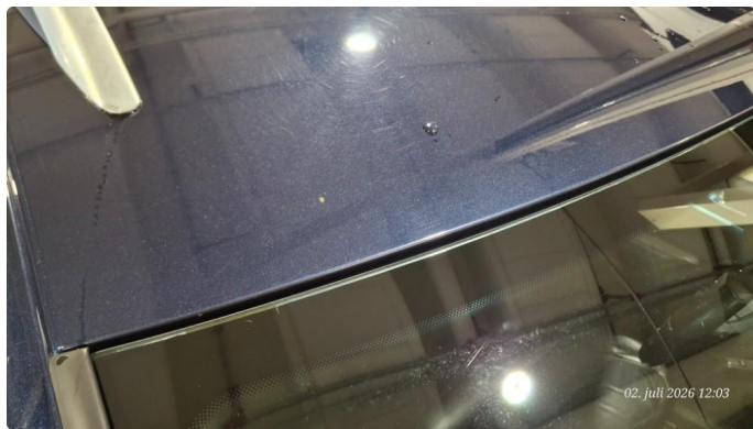
1.8 Steinsprut med rust
