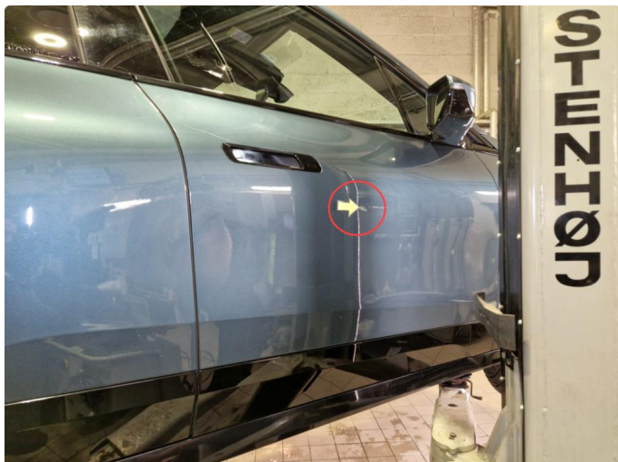
1.1 Liten p-bulk h-framdør ( Normal bruksslitasje )
