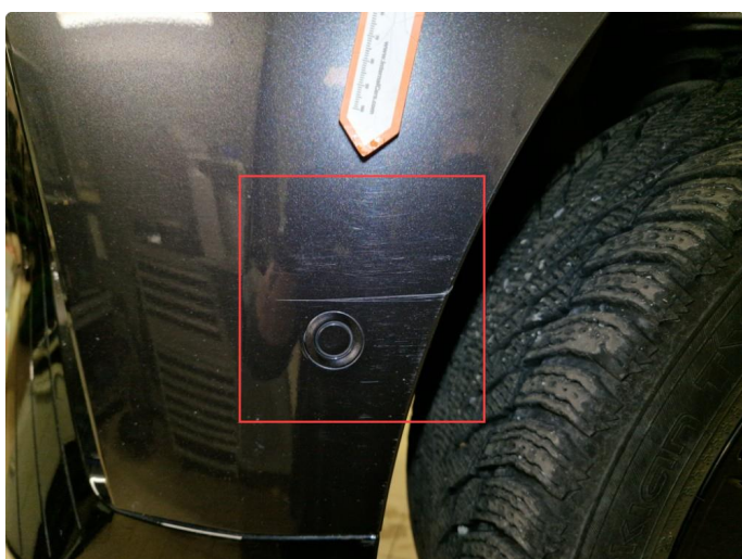
1.3 Noen bruksmerker, ikke noe ut over normal bruksslitaje. Noe kan komme bort ved polering.
