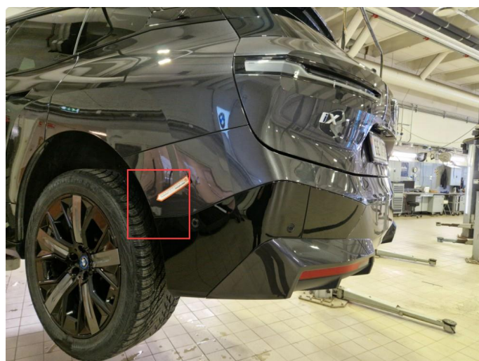
1.4 Noen bruksmerker, ikke noe ut over normal bruksslitaje. Noe kan komme bort ved polering.
