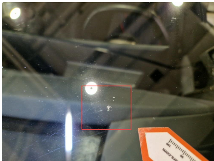
1.4 Noen små steinsprut frontrute , for små til og repareres pr. nå ,normal bruksslitasje.
