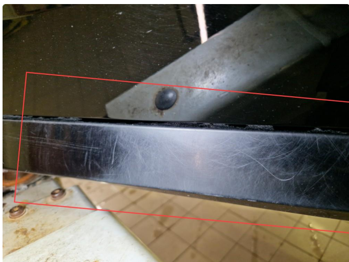
1.5 Riper kanalskjørt h+v side, normal bruksslitasje.
