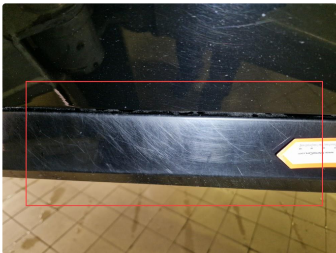
1.5 Riper kanalskjørt h+v side, normal bruksslitasje.
