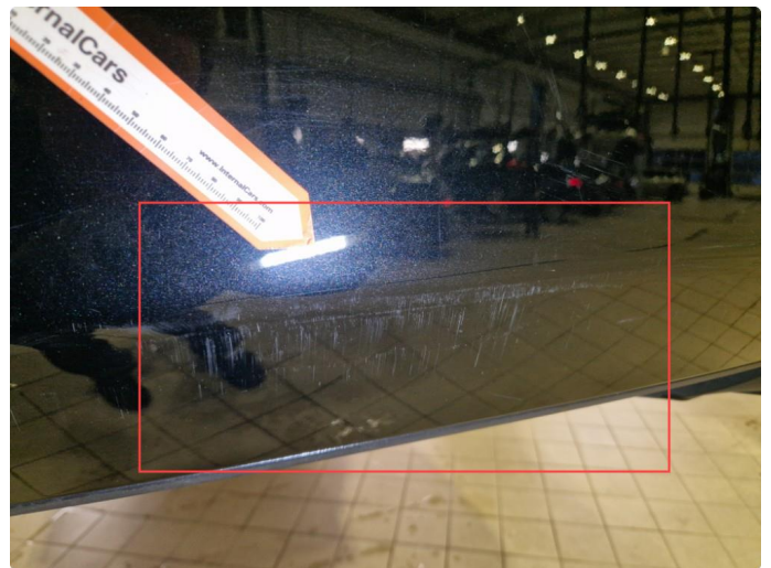
1.3 Noe riper bakfanger / innlastingssone, normal bruksslitasje.
