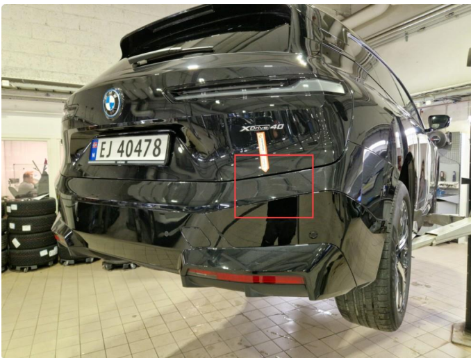
1.3 Noe riper bakfanger / innlastingssone, normal bruksslitasje.
