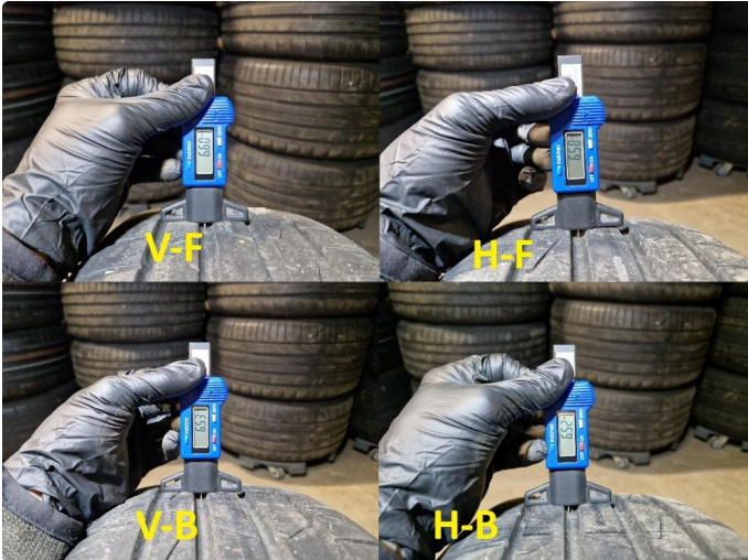
1.2 Dekkdybdemåling sommerdekk utført 26.03.2026 på km : 9.177
