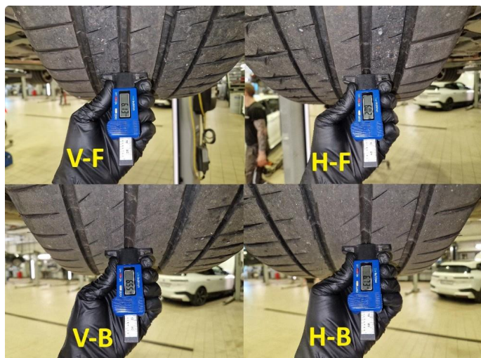
1.2 Dekkdybdemåling sommerdekk utført 16.07.2026 på km : 4.715
