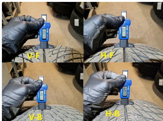
1.3 Dekkdybdemåling vinterdekk utført 16.07.2026 på km : 4.715
