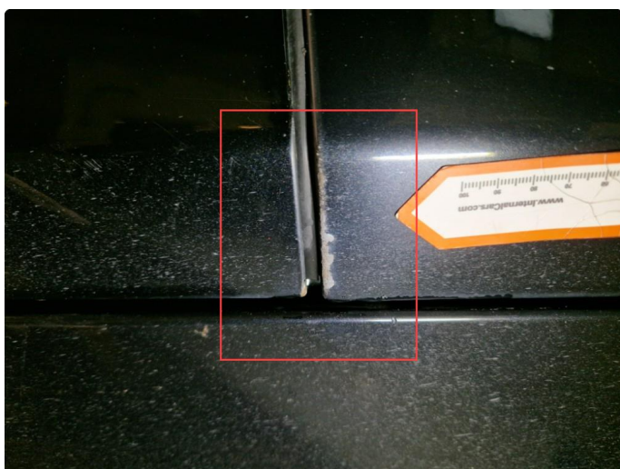
2.1 Lakkslitasje fremre nedre del v-bakdør.
