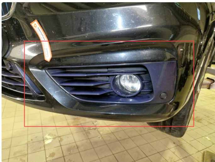
2.6 Skadet midtre pyntegrill frontfanger.
