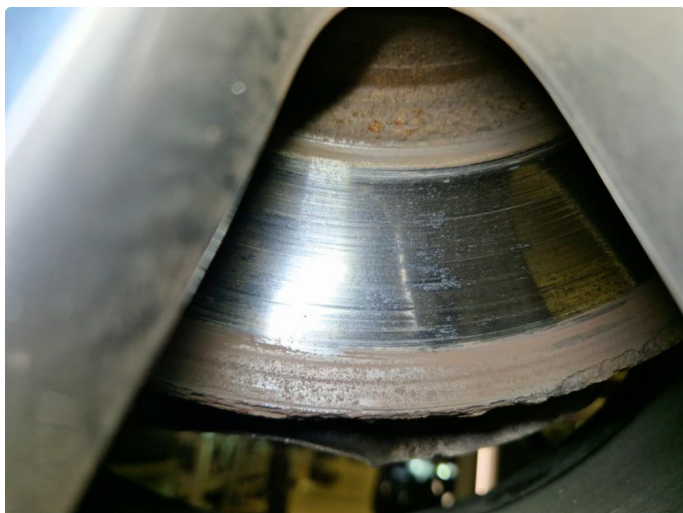
6.1 Rust / slitasje bremseskiver fram , bremseklosser målt til 10mm.
