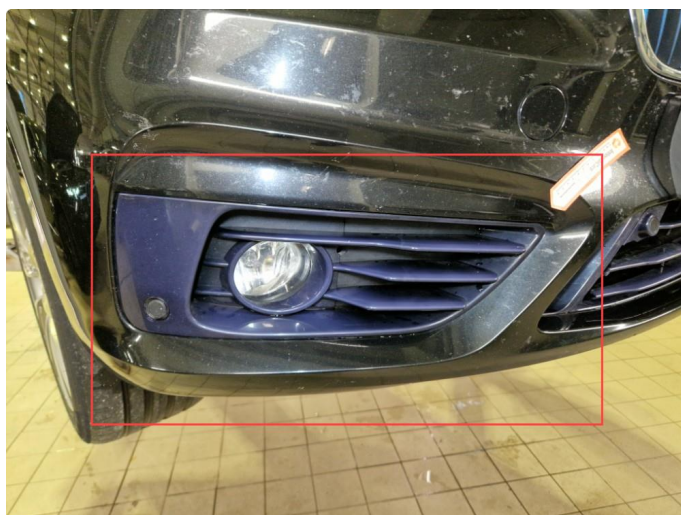
2.6 Skadet midtre pyntegrill frontfanger.
