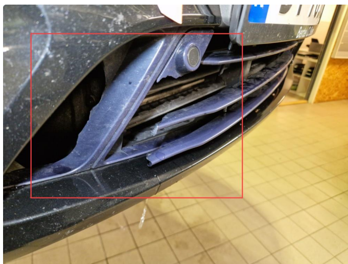
2.6 Skadet midtre pyntegrill frontfanger.
