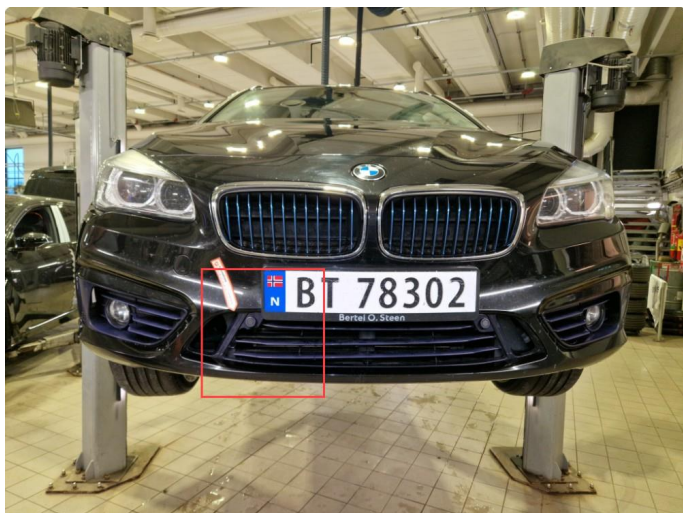
2.6 Skadet midtre pyntegrill frontfanger.
