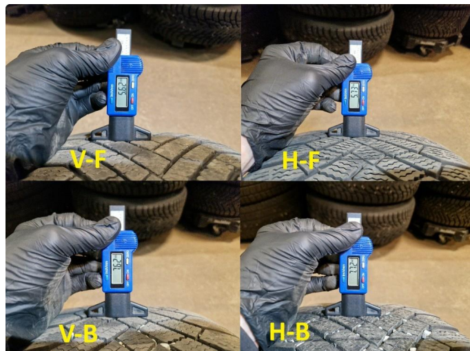
1.2 Dekkdybdemåling vinterdekk utført 28.09.2026 på km : 17.003.
