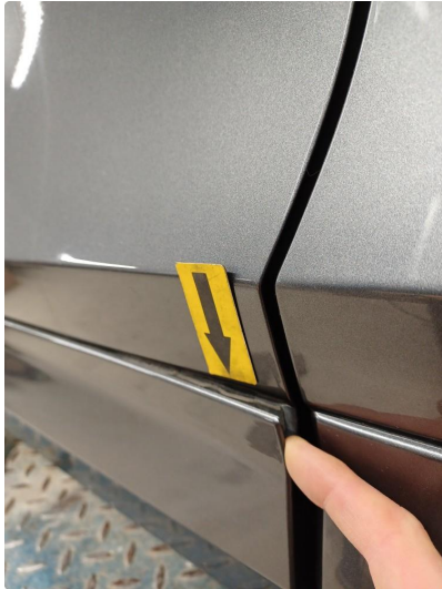
2.1 Nedre list på dør v.f har begynt å løsne
