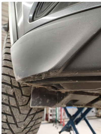
1.1 Skrubbskader underkant - bruksmerker, normal iht. kmstand og alder
