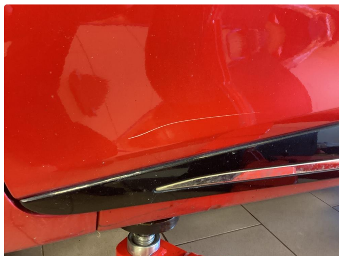
1.4 Ripe ned til grunning
