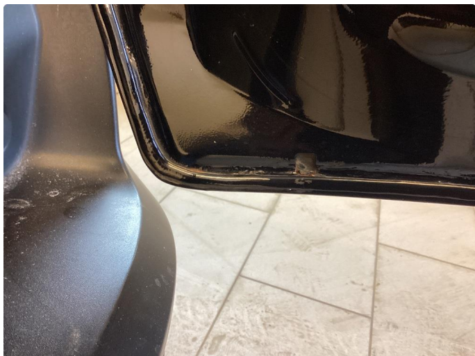
2.1 Rust i fals
