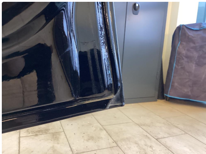
2.1 Rust i fals
