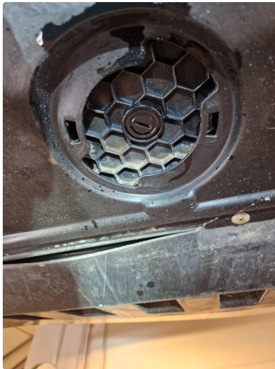
2.1 Oljelekkasje fra motor
