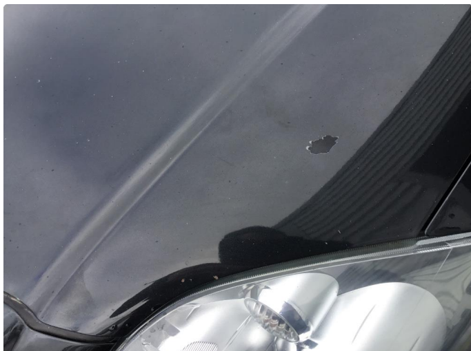
1.4 Lakkflassing av klarlakk på et punkt på panser.
