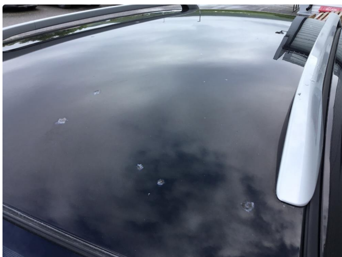
1.9 Flere rustflekker på tak. To på en cm, tre på en og en halv cm og tre på to cm.
