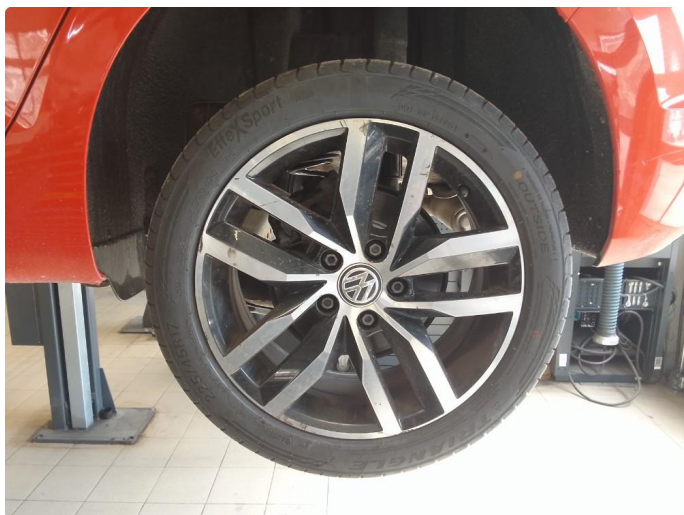
1.4 Alle 4 felger for sommerhjul er skadde/kantkjørte
