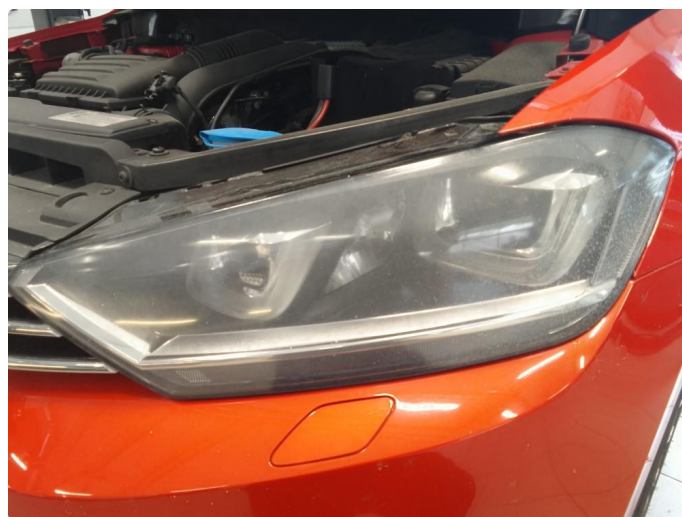
2.1 Er matte/krakelerte hovedlykteglass BS foran
