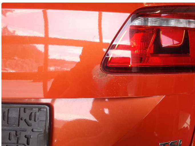
1.3 Bakluke har rustskade ved lykt
