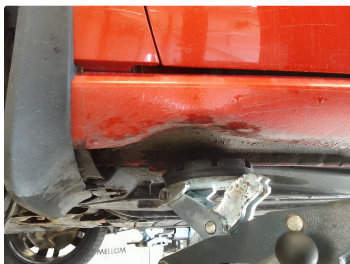
1.6 Kanal BS fremre er trykket opp ved jekkfeste
