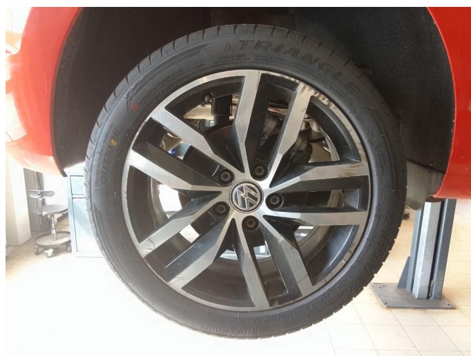
1.4 Alle 4 felger for sommerhjul er skadde/kantkjørte
