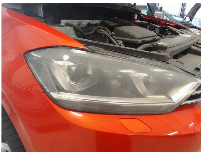
2.1 Er matte/krakelerte hovedlykteglass BS foran
