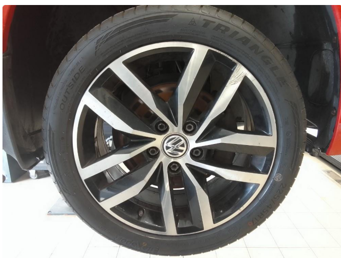
1.4 Alle 4 felger for sommerhjul er skadde/kantkjørte
