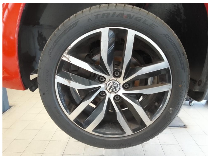
1.4 Alle 4 felger for sommerhjul er skadde/kantkjørte
