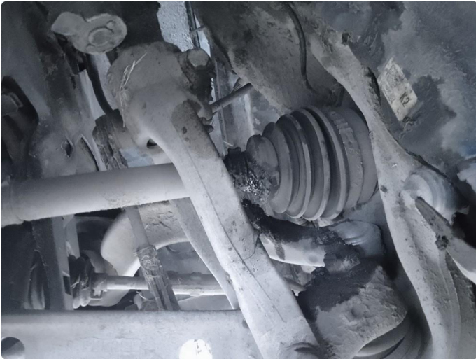
3.1 Drivakselmansjett er sprukket
