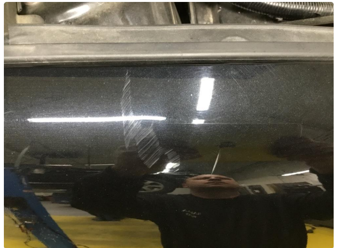
1.2 Ripe(r) ned til grunning
