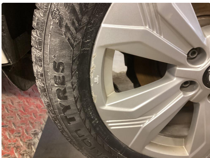
1.3 Kantkjørt felger (blir byttet)
