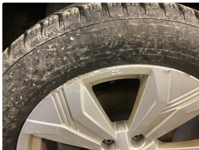
1.3 Kantkjørt felger (blir byttet)
