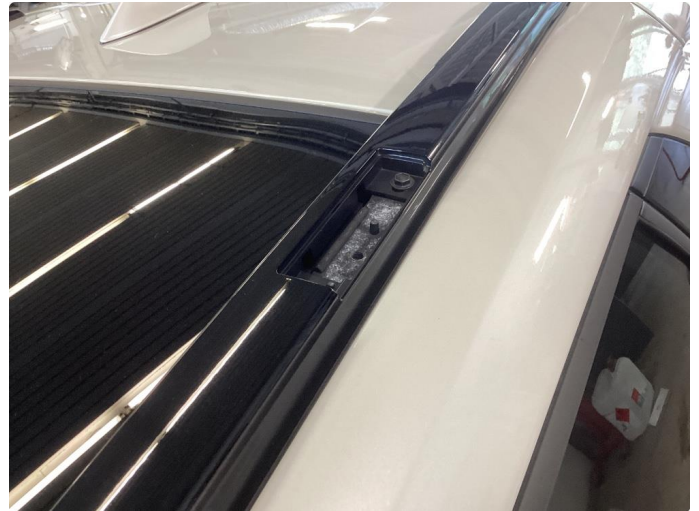
1.2 Mangler ett deksel
