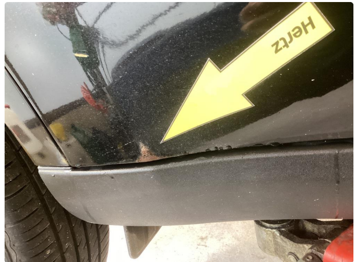
1.2 Litt rust/korrosjon nede bakdører
