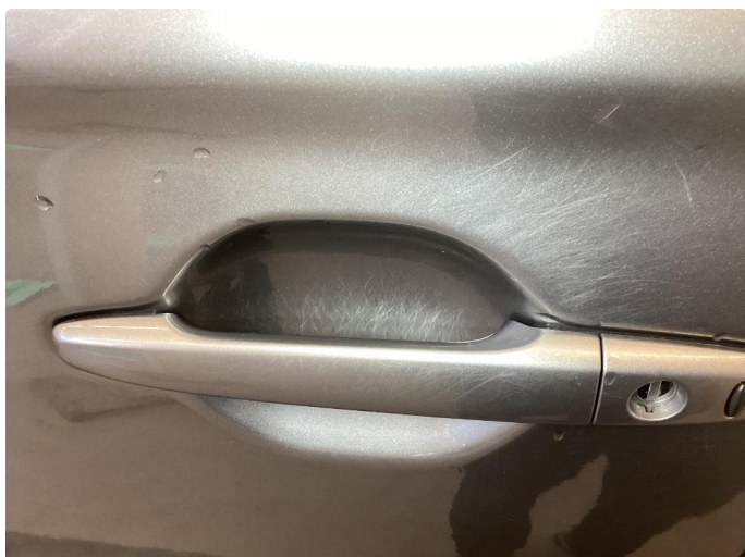
1.1 Riper etter inn og utstiging dørhåndtak
