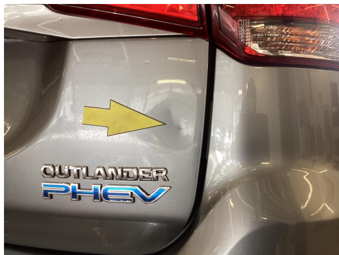
1.2 Liten svak bulk uten lakkskade
