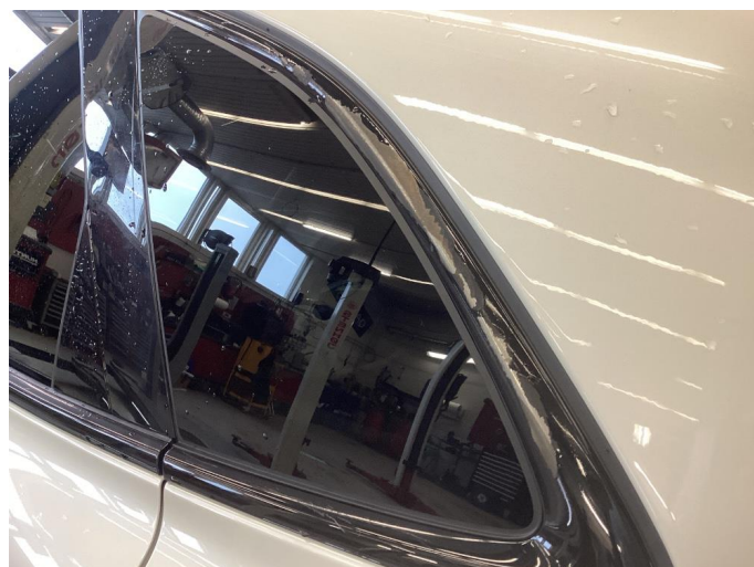
1.3 Litt avflakking pyntelist rundt vindu
