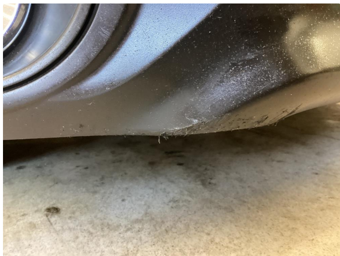
1.7 Lett skrubbemerke under fanger
