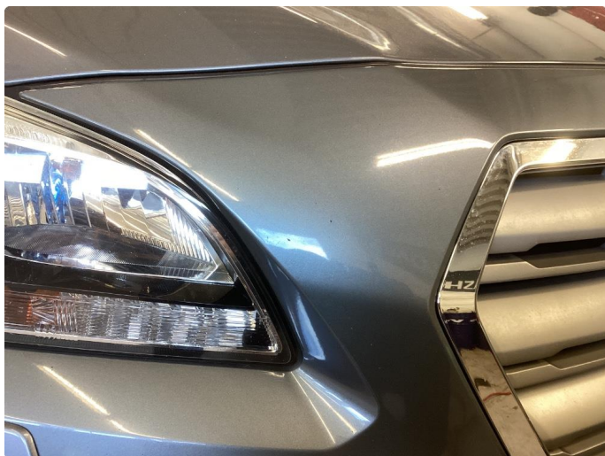
1.6 Bitte litt steinsprut
