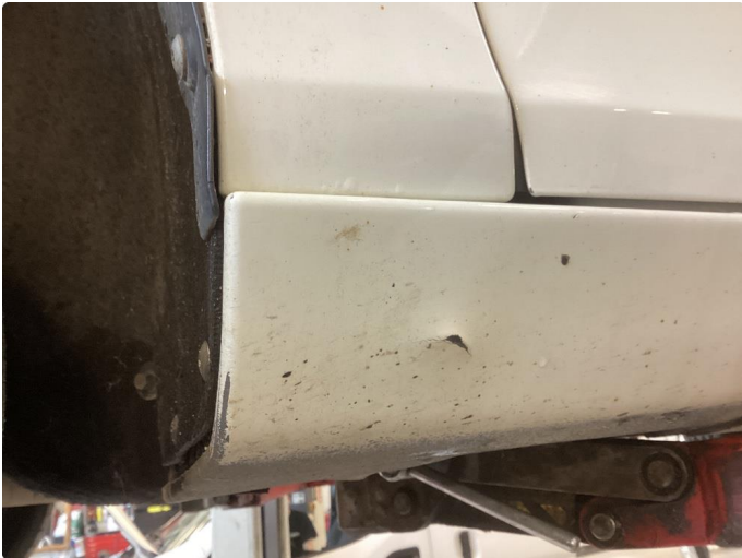
1.1 Lett skade nede på kanal
