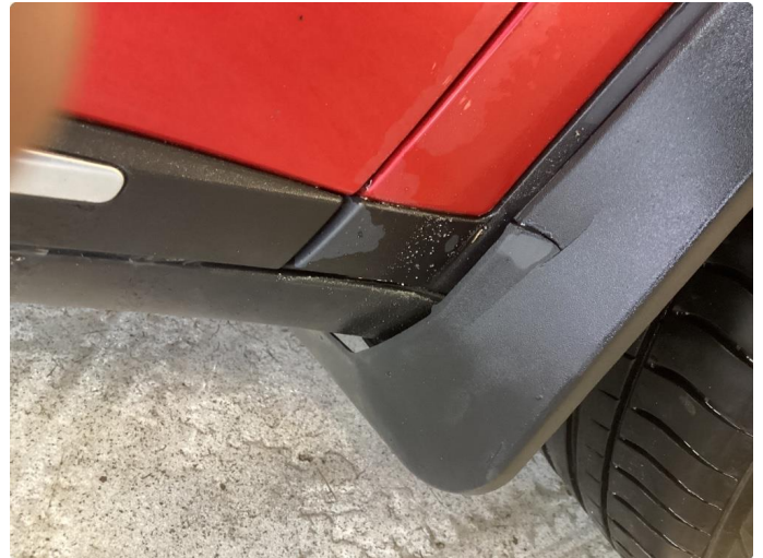
1.2 Skade i skvettlapp
