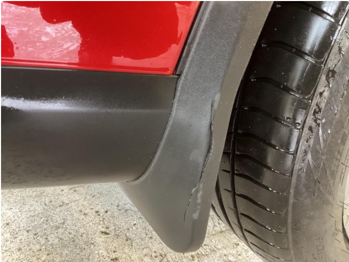
1.1 Skade i skvettlapp
