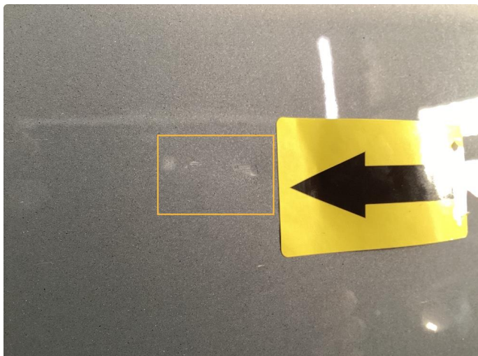
1.1 Bulk med lakkskade OK
