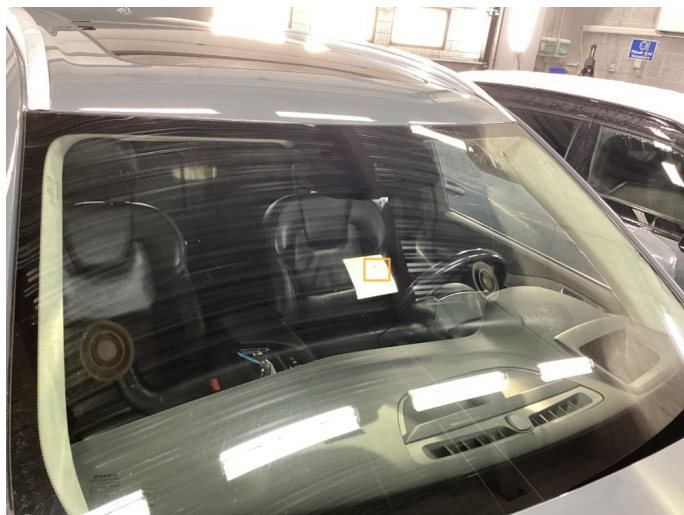
1.7 Steinsprut med sprekk. OK
