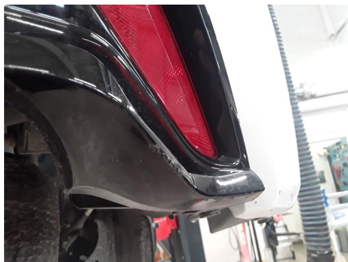
1.3 Små riper under på støtfanger.
