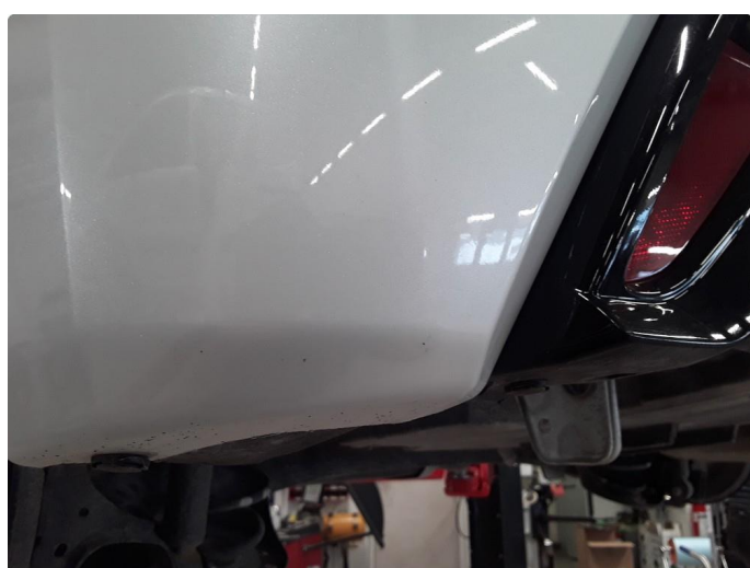
1.3 Små riper under på støtfanger.
