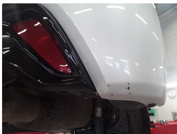
1.3 Små riper under på støtfanger.
