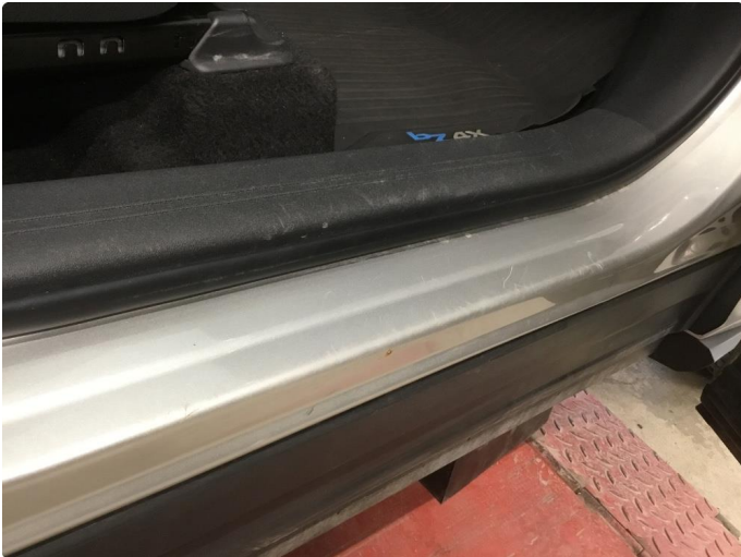
1.1 Litt slitasje på innsteg
