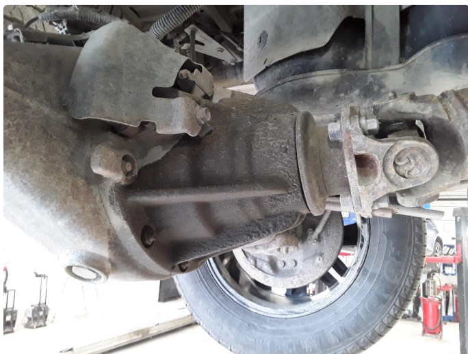
3.1 Antydning til svette rundt diff bak.
