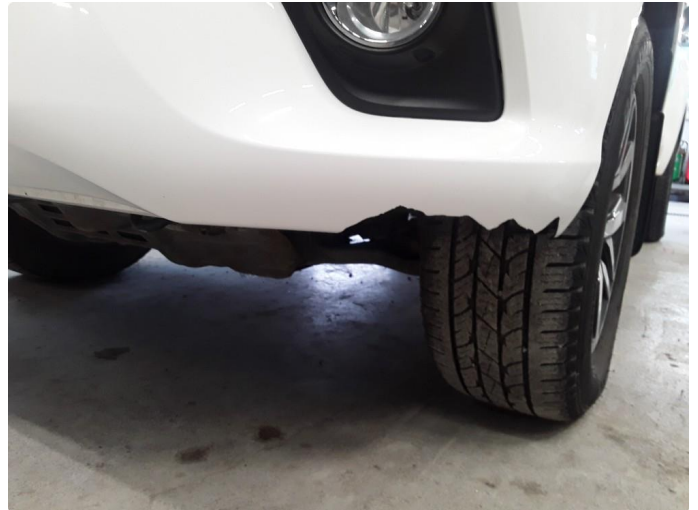
1.4 Liten skade i plast på støtfanger foran.
