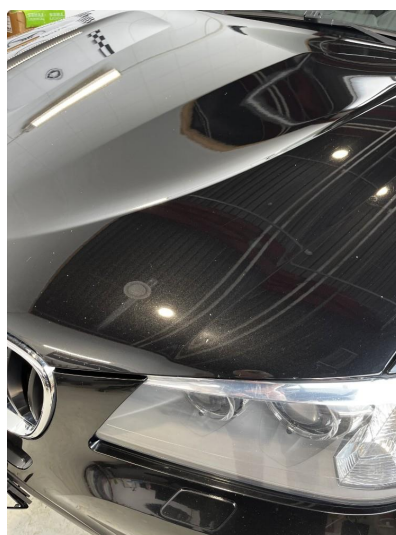
1.1 Generelt mye bruksslitasje
