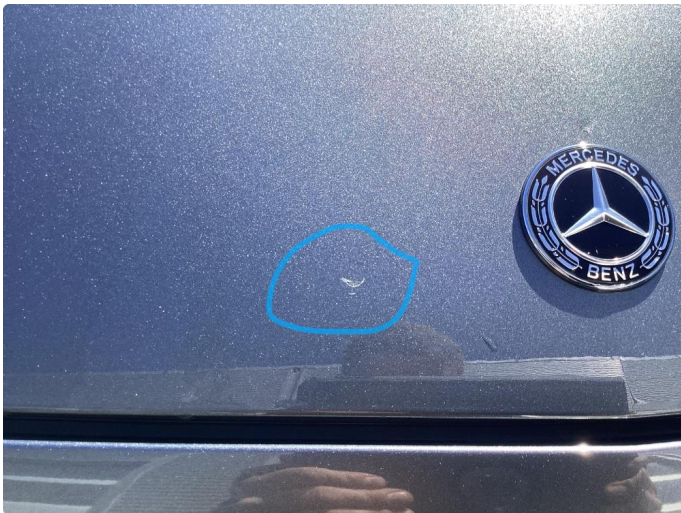
1.1 Noe stensprut i panser
