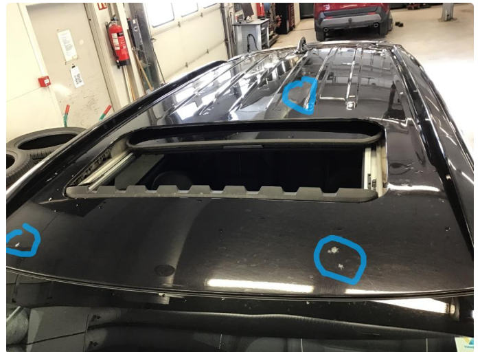
1.2 Taket er opplakkert på grunn av steinsprang.
