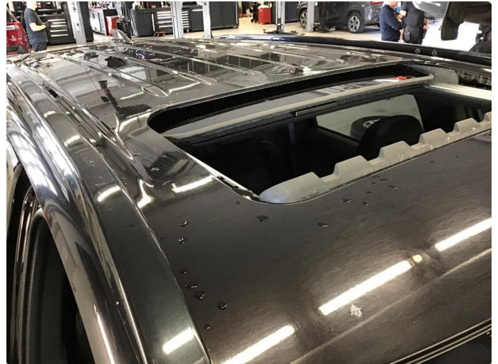
1.2 Taket er opplakkert på grunn av steinsprang.
