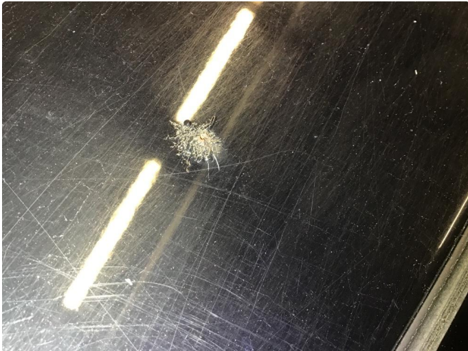
1.2 Taket er opplakkert på grunn av steinsprang.
