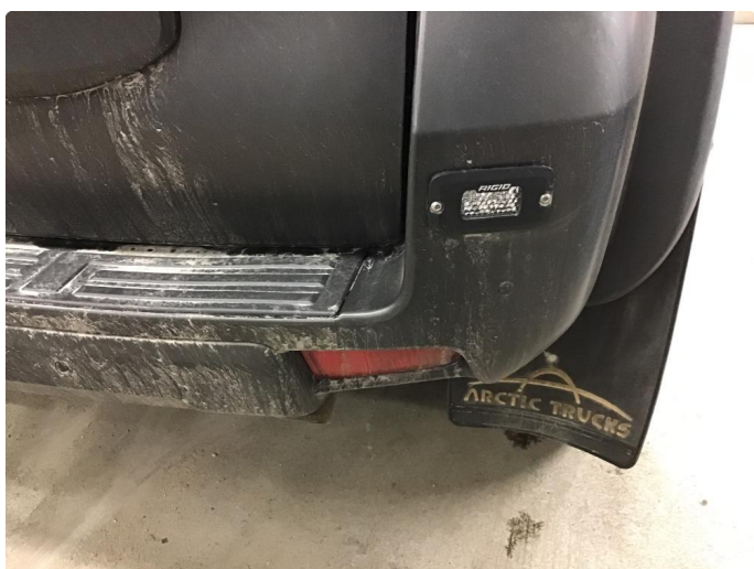
2.2 Det står 2 lykter bak på fanger som er blombert, de har hvert til ekstra ryggelys disse er ikke godkjernt dermed koblet ut.
