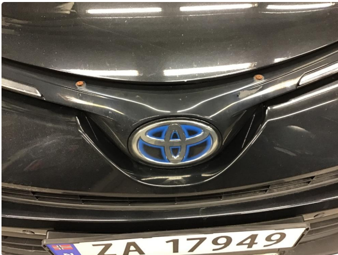
1.2 Lakkavskalling på grill ettet ekstra lys
