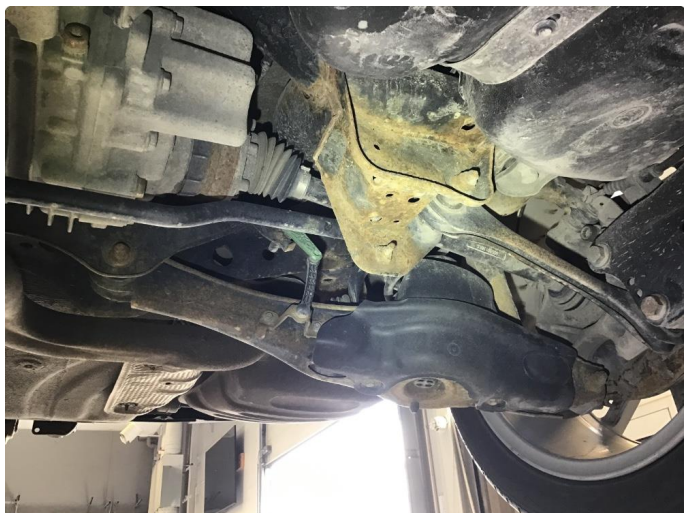
1.2 Bilen er rustbehandlet under.
