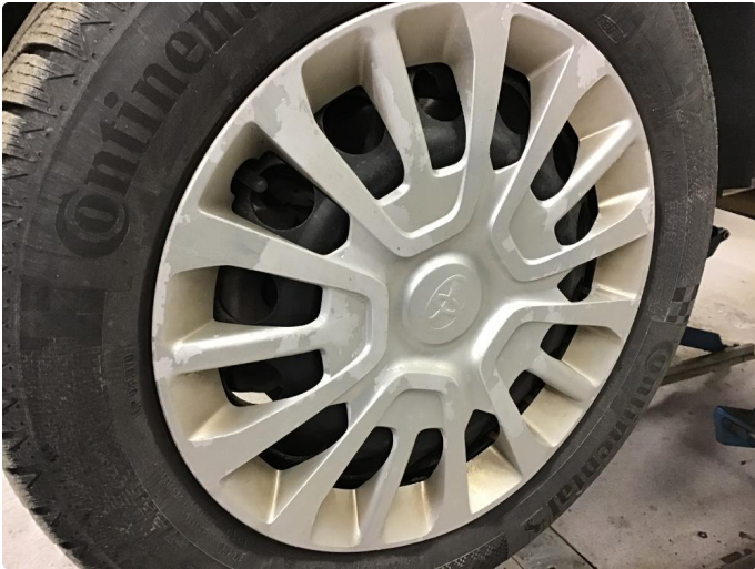
1.2 Noe lakk avskalling på hjulkapsler.
