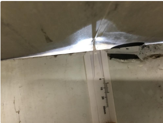
2.1 Ripe/bulk ca.20cm.lang og ca.5mm. på det dypeste i beskyttelsesplate under batteri. Ifølge VW så er det akseptabelt med skrapeskader/bulk på 5mm. i beskyttelsesplate.
