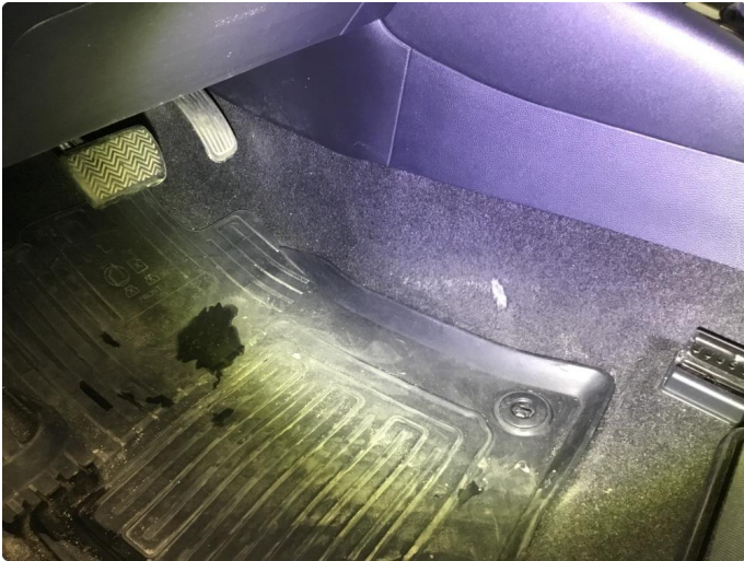
2.1 Slitemerke i teppe førerside mot tunnel.
