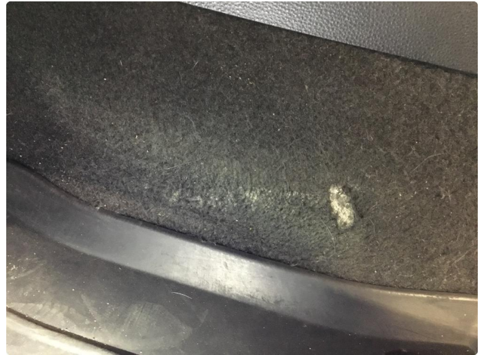
2.1 Slitemerke i teppe førerside mot tunnel.
