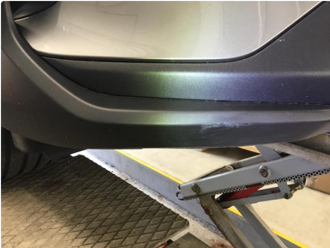
1.1 Noen riper i svart plast innunder høyre fangerhjørne foran(Normal bruksslitasje)
