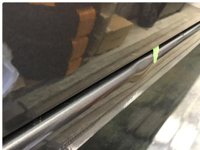
1.1 Bulk uten lakkskade, kanal h.side. Bruksslitasje.
