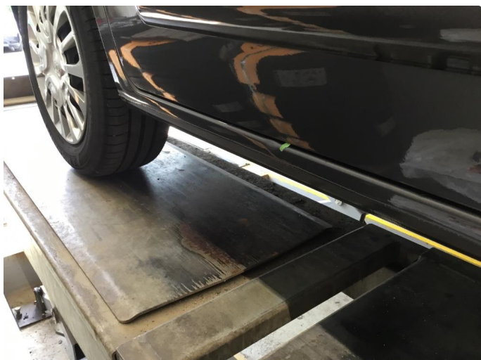
1.1 Bulk uten lakkskade, kanal h.side. Bruksslitasje.
