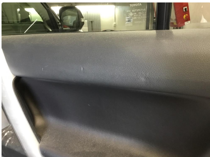
2.1 Noe merker i dørtrekk høyre bakdør. Bruksslitasje.
